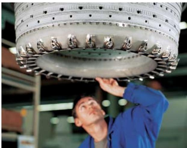
Instandsetzung der Brennkammer eines CF6-50 bei der MTU Maintenance Hannover (Bild: MTU).
