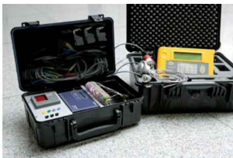
Messausstattung mit Energiemesser, Datenlogger und Volumenstrommesser
